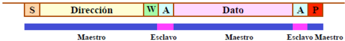
Figura 10-2. Protocolo I2C Maestro-Esclavo
