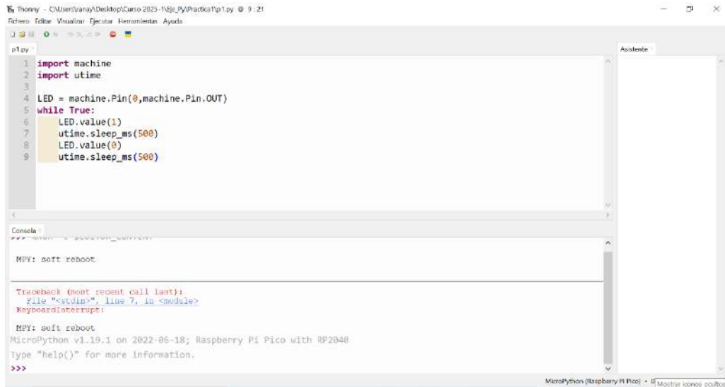
Figura 3-10. Detener ejecución y en espera
